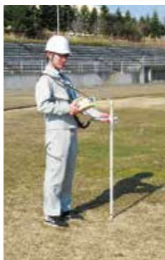
サーベイメータによる測定
