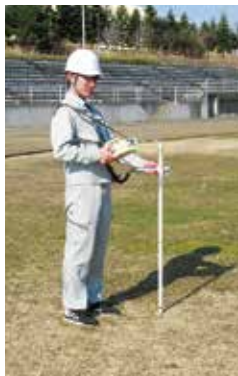
サーベイメータによる測定
