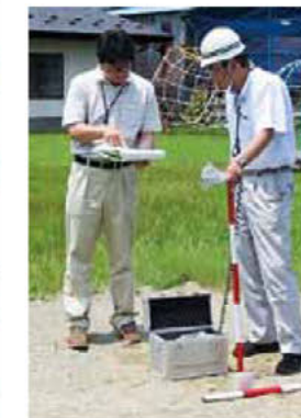
サーベイメータによる測定
