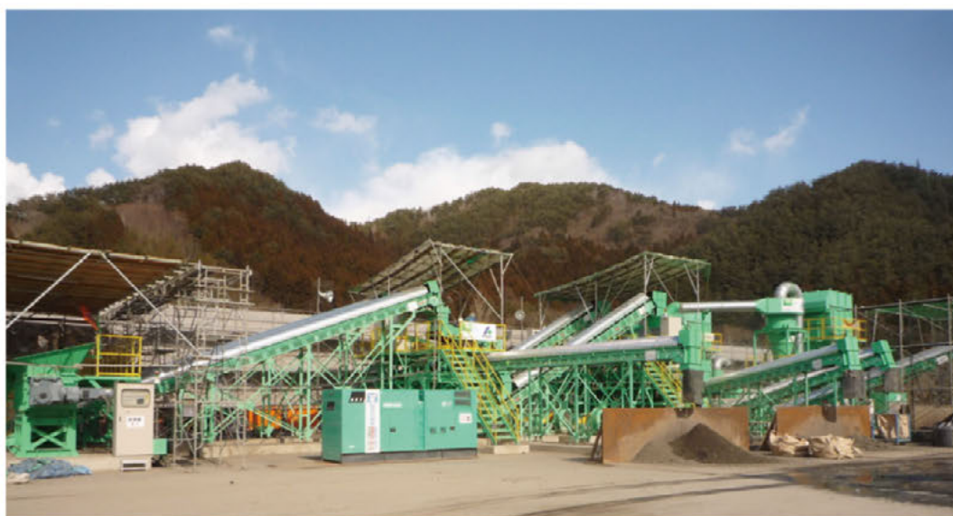
写真 3.5.11 比重差選別機システム
