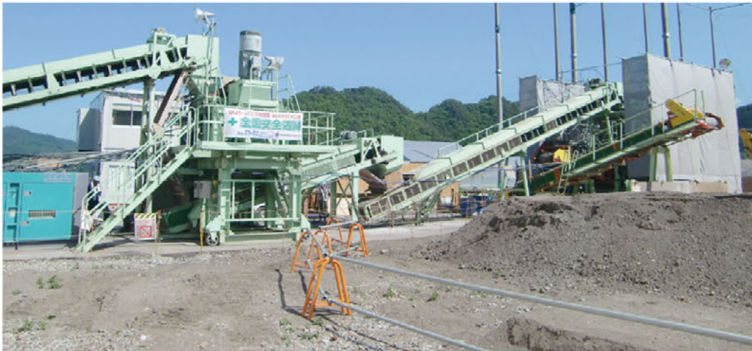
写真 3.5.12 高速回転式破碎混合機
