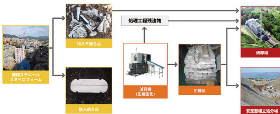
図 3.5.4 減容化の処理の流れ
