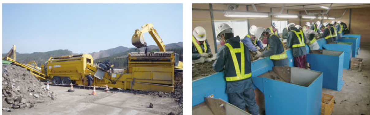
写真 3.5.2 選別処理の状況（左：大槌地区・回転選別機、右：釜石市・手選別）
